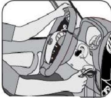
Posición de bloqueo de la palanca de inclinación
