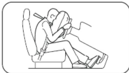
Los airbags se desinflan enseguida por los poros del cojín del airbag. El airbag, por lo tanto, no sustituye a los cinturones de seguridad. Para maximizar siempre su protección, lleve siempre puesto el cinturón de seguridad. El airbag solamente puede funcionar con la llave de encendido en posición 'ON'.
