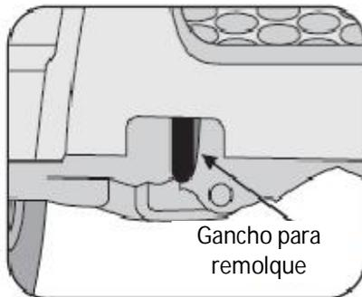
Ganchos para remolque delantero y trasero: Su Scorpio lleva dos argollas para remolque. El gancho para remolque delantero debe utilizarse cuando sea necesario remolcar el vehículo, y el gancho de remolque trasero debe utilizarse para remolcar otros vehículos.
