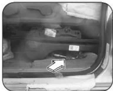
Llave de ruedas y palanca del gato (cabina simple): La llave de ruedas se encuentra debajo del asiento del conductor.
