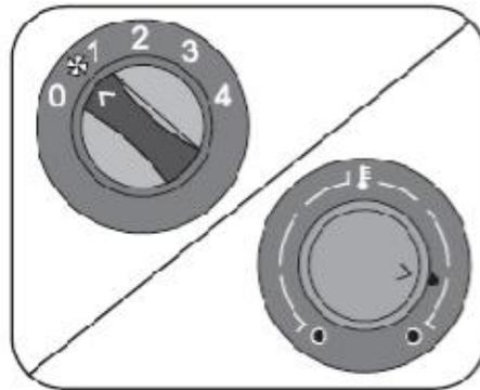
Botón de control de velocidad de ventiladores: La velocidad del ventilador puede regularse girando el botón de control de velocidad de ventiladores.
