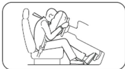
Los airbags se desinflan enseguida por los poros del cojín del airbag. El airbag, por lo tanto, no sustituye a los cinturones de seguridad. Para maximizar siempre su protección, lleve siempre puesto el cinturón de seguridad. El airbag solamente puede funcionar con la llave de encendido en posición 'ON'.
