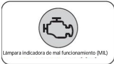
Lámpara indicadora de mal funcionamiento (MIL)
