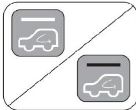
Interruptor selector de aire exterior / recirculación de aire:
