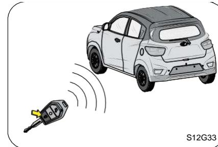
Utilizzando l'RKE, è possibile bloccare/allarmare o sbloccare/disinserire l'allarme della vettura da distanze di circa 9 m.
