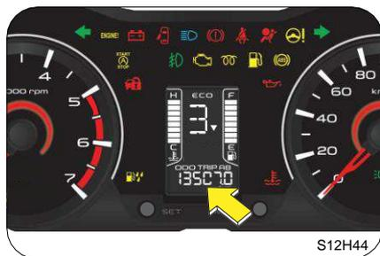
La fila inferiore del display LCD indica la lettura del contachilometri. Il contachilometri registra e visualizza la distanza totale percorsa in km.
