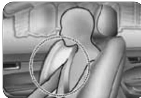
Il veicolo è dotato di airbag laterali su entrambi i sedili anteriori. Lo scopo dell'airbag è fornire una protezione aggiuntiva al conducente del veicolo e/o al passeggero anteriore rispetto a quella offerta solo dalle cinture di sicurezza
