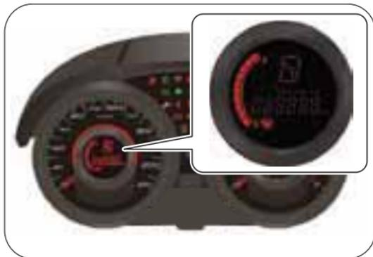
L'indicatore del livello di carburante del motore funziona solo a macchina accesa. Fornisce lo stato del livello del carburante nel serbatoio. F indica che il serbatoio è pieno (55 litri), E indica che il serbatoio è vuoto.
