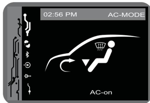
L'aria viene scaricata attraverso le bocchette nel vano piedi/pavimento, le bocchette del parabrezza, di sbrinamento laterale sul cruscotto.
