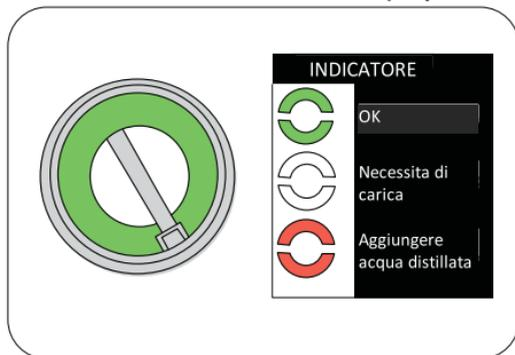
Un indicatore di carica della batteria è previsto per le batterie Exide per visualizzare lo stato di carica con un colpo d'occhio.
