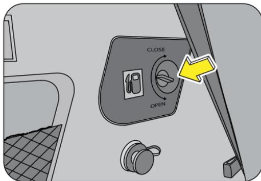
Nell'improbabile caso in cui l'interruttore a distanza non apre il coperchio del carburante, è fornito un comando di rilascio manuale. Si trova nell'area sinistra del vano bagagli dietro la terza fila di sedili.
