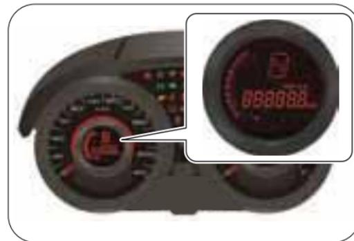
Il contachilometri registra e visualizza la distanza totale guidata in km. Premere il pulsante reset (A) per passare da contachilometri a contachilometri totale. Il contachilometri non può essere azzerato.
