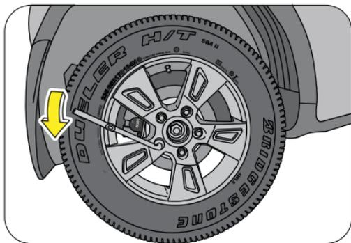
Allentare sempre i bulloni delle ruote prima di sollevare il veicolo. Girare i dadi della ruota in senso antiorario per allentare. Per ottenere il massimo livellamento possibile, inserire la chiave nel dado in modo che la maniglia sia rivolta sul
