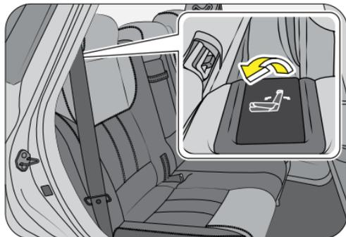
Per cambiare l'angolo dello schienale dei sedili della seconda fila, inclinarsi leggermente mentre si solleva la leva di inclinazione sull'angolo superiore dello schienale, inclinare nella posizione desiderata e rilasciare la leva di inclinazione. Assicurarsi che la leva di inclinazione torni nella posizione originale e che lo schienale sia bloccato in posizione oscillando avanti/indietro il sedile.
