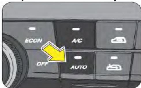
El modo Auto puede usarse para controlar el funcionamiento del aire acondicionado del vehículo de
