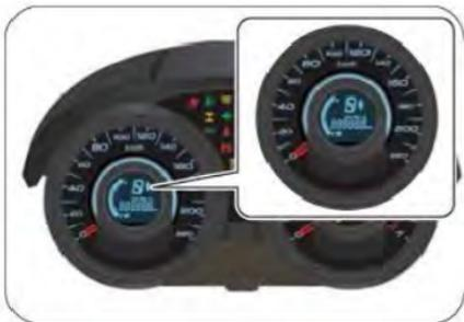
El indicador de combustible solo funciona cuando el motor está encendido. Indica el nivel de combustible del depósito. F indica que está lleno (70 litros), E indica que está vacío.
