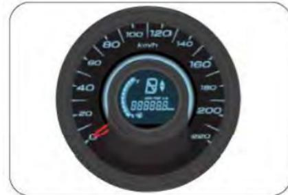
El velocímetro indica en tiempo real la velocidad del vehículo en kilómetros por hora.
