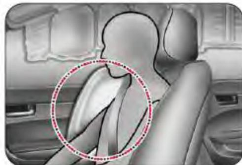
Su vehículo está equipado con sendos airbags laterales para ambos asientos delanteros. El propósito de los airbags es proporcionar al conductor o al copiloto protección adicional a la ofrecida por el cinturón de seguridad.
