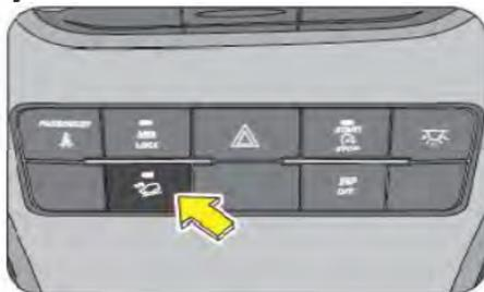
Esta función ayuda al conductor a descender una pendiente (de una inclinación máxima del 50%) mediante el empleo de los frenos, de tal manera que se limite la velocidad del vehículo sin la intervención del conductor.
