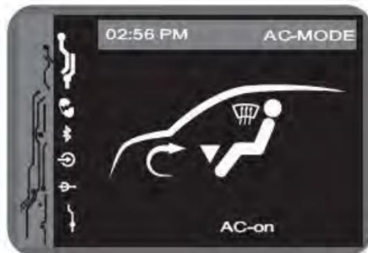
El aire es expulsado a través de las salidas de aire inferiores, del parabrisas y laterales del salpicadero.
