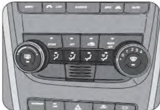
El botón modo de distribución le permite seleccionar los tipos de salida de aire siguientes:
