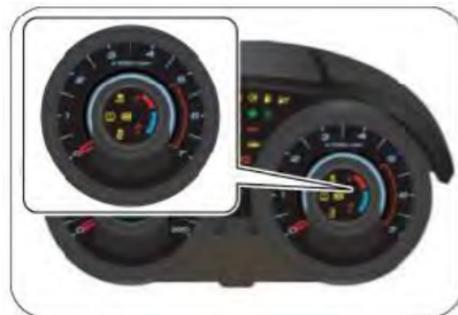
Bajo condiciones normales, la aguja debería estar debajo de la parte roja. Cuando la aguja llega a la zona roja, la luz de aviso de alta temperatura se encenderá. En esta situación apague el aire acondicionado y mire a ver si la temperatura baja. Si no, pare el vehículo y deje que el motor se enfríe. Chequee el nivel de líquido refrigerante si fuera necesario. Si el motor aún está caliente contacte a su concesionario oficial Mahindra más cercano.
