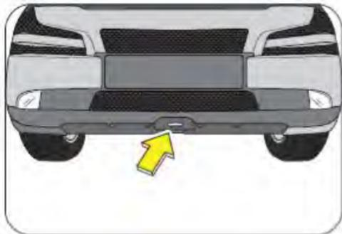
Si es necesario remolcar su vehículo, llame a un profesional para dicha operación. Si es imposible conseguir un servicio profesional de emergencia para esta operación, otro vehículo puede remolcar de forma temporal su vehículo mediante un cable o una cadena amarrada de forma segura al gancho de remolque ubicado en la base de ensamble del vehículo.
