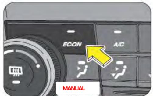
El botón ECON activa el modo de ahorro. Durante el funcionamiento del aire acondicionado en modo ECON, el sistema se para automáticamente a una temperatura más elevada de cómo lo haría en modo normal. Este modo se puede usar en condiciones meteorológicas poco adversas para mejorar la eficiencia del carburante. El nivel de confort puede no ser el ideal bajo este modo.
