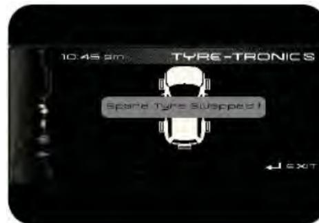
Presione el botón de TPMS del cuadro de instrumentos a fin de actualizar el sistema. La luz de advertencia del TPMS continuará encendida si la rueda de repuesto no tiene la presión o la temperatura adecuadas. Tras corregir dichas anomalías, presione el botón del TPMS para informar al sistema de que se ha rectificado las anomalías a fin de que se apague el testigo del cuadro de instrumentos y de la pantalla de infoentretenimiento.
