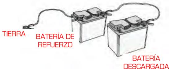
5. Conecte siempre POSITIVO CON POSITIVO y NEGATIVO CON LA CONEXIÓN A TIERRA (por ejemplo, tornillo de montaje de la suspensión, soporte del elevador del motor, entre otros) pero nunca a la batería. No utilice como conexión a tierra las líneas de combustible, las cubiertas del balancín del motor o los conectores de entrada.
