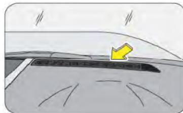
En su vehículo hay 4 salidas de aire para desempañar: 2 de laterales y 2 para el parabrisas; que se encuentran justo debajo del parabrisas. Las salidas de aire desempañantes de los laterales evitan que los cristales frontales se empañen, y las del parabrisas ayudan a eliminar el vaho del parabrisas
