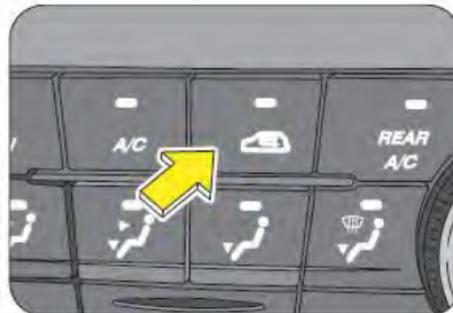
Para ajustar el sistema HVAC en modo de aire exterior, presione el botón de modo de recirculación otra vez. La luz LED del botón cambia a OFF, indicando que el modo de recirculación está activado.
