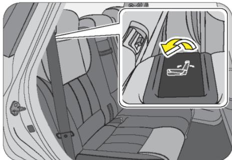
Para modificar el ángulo de los asientos de la segunda fila, eche el asiento un poco hacia adelante a la vez que levanta la palanca de reclinación ubicada en la esquina superior del asiento y llévelo hacia atrás hasta alcanzar la posición deseada; suelte la palanca una vez logre la posición deseada. Asegúrese de que la palanca de reclinación vuelva a su posición original y de que el asiento esté en su sitio moviéndolo hacia adelante/hacia atrás.
