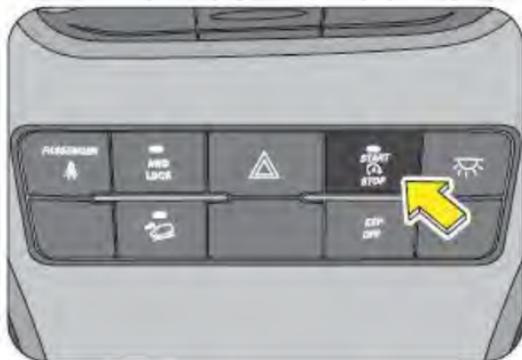
El sistema de Start/Stop inicia y detiene automáticamente el motor cuando esté a ralentí o en atascos de tráfico. Esta función permite una mayor eficiencia del combustible. El sistema se activa por defecto en cada ciclo de ignición. Puede desactivarse pulsando el botón Stop/Start que hay en el cuadro de mandos del salpicadero.
