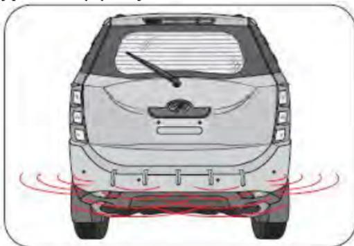
El Sistema de asistencia de aparcamiento marcha atrás IntelliPark es un sistema que ayuda al conductor a conducir en marcha atrás a una velocidad menor de 5 km/h.
