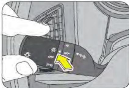
Esto aparecerá indicado en la pantalla de información con una luz. Para desactivar el modo automático de luces haga la operación descrita con anterioridad a la inversa, colocando las luces en posición OFF.
