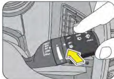
Gire el rotador externo de la palanca del limpiaparabrisas y alinéelo con "ON" para activar el limpiaparabrisas trasero.
