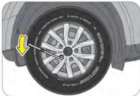
Afloje siempre las tuercas de la rueda antes de levantar el vehículo girándolas en el sentido de las agujas del reloj. Para ejercer la máxima palanca, fije la llave inglesa a la tuerca de tal modo que el mango esté mirando hacia arriba.
