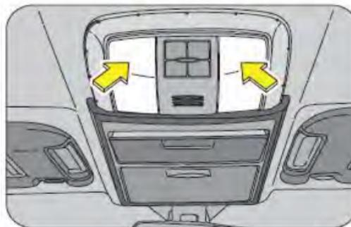
Las luces de techo frontales están situadas en la consola del techo encima del retrovisor. La lámpara se enciende presionando el lente de la misma. Presiónelo otra vez para apagar la lámpara.
