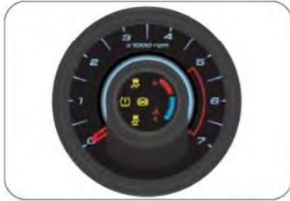
El tacómetro indica en tiempo real la velocidad de rotación del motor en RPM (revoluciones por minuto). Cada división son 500 RPM. Llevar el motor a altas revoluciones lleva al motor a consumir mucha gasolina. Mantenga las revoluciones alrededor de 2500 RPM y no acelere o frene bruscamente.
