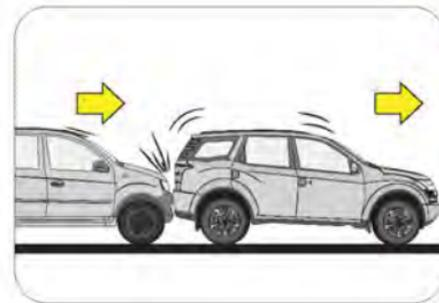
Los airbags frontales no han sido diseñados para inflarse en colisiones traseras, donde los ocupantes se desplazan hacia atrás por la fuerza del impacto. En este caso, los airbags inflados no proporcionarían protección alguna
