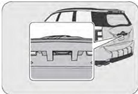
El portón del maletero puede abrirse de manera manual pulsando el botón que hay en el aplique trasero. Para cerrar el portón del maletero, baje la puerta hasta la mitad y deje que se caiga por su propio peso; la puerta se cerrará automáticamente.
