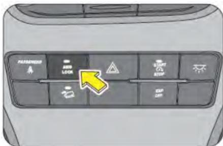
En un vehículo equipado con AWD, la potencia se transmite a todas las ruedas. Este sistema se acciona a través del sistema de Gestión Interactiva del PAR (ITM, por sus siglas en inglés), que transfiere el par motor a las cuatro ruedas de forma inteligente. El sistema ITM incluye un embrague electromagnético, controlado por un ECU. Según el modo de conducción, este sistema envía el par motor a las ruedas traseras de manera automática.
