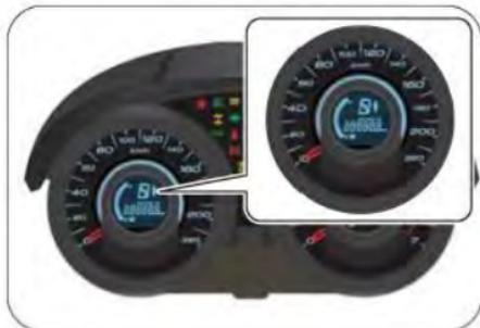
El odómetro registra y muestra el total de la distancia viajada en kilómetros. Presione el botón de reseteo [A] para cambiar entre el odómetro y el contador parcial de kilómetros. El odómetro no puede ser reseteado
