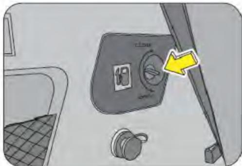
En el improbable caso de que el botón no abra la tapa del depósito, podrá abrirla mediante un sistema mecánico. Vaya al compartimento para el equipaje y en la zona final detrás de la tercera fila de asientos encontrará un mecanismo manual para abrir el depósito.
