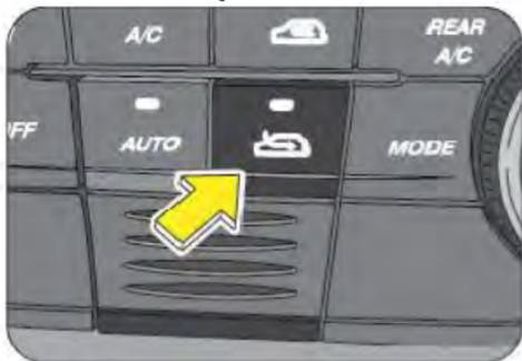
Para ajustar el sistema HVAC en modo de aire exterior, presione el botón de modo de aire exterior. La luz LED del botón se ilumina indicando que el modo de aire exterior está activado.
