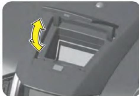
El multi-box se encuentra encima de la pantalla de información en la consola central. Puede ser usado para guardar pequeños objetos como móviles, carteras, tiquets, etc., Para abrirlo, presiónelo suavemente. Para cerrarlo llévelo hasta abajo hasta que se cierre.
